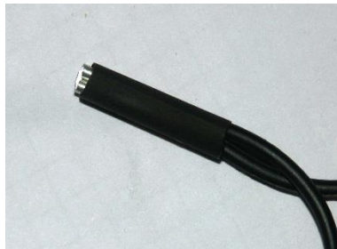
5) Shift the hose on the plug
