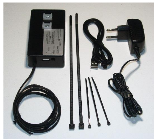
Bild 4: Lieferumfang: Harvester, Netzteil, USB-Kabel, Kabelbinder
