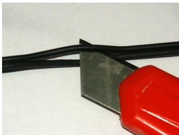
1) Trennen der beiden Adern mit scharfem Messer
