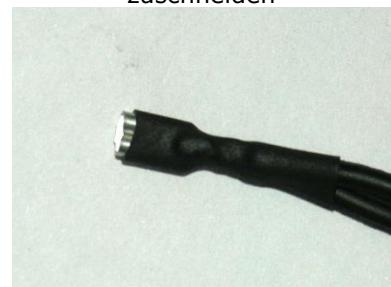
6) Schrumpfen mit LötKolben oder Föhn
