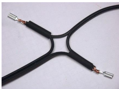
4) Schrumpfschlauch aufschieben und Stecker anlöten
